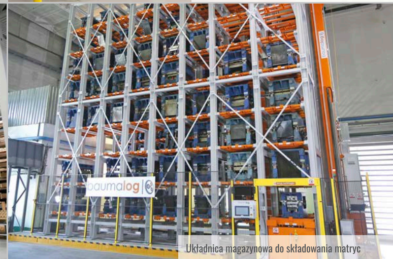
TwinTower® zintegrowany z wycinarką laserową
