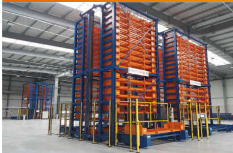
Podwójne okno dostępne: załadunkowe od frontu i rozładunkowe z podwójnym systemem dostarczania półek – z tyłu
